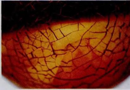
图 10 再造琥珀表面冰裂纹掩盖下的颗粒边界 16×
