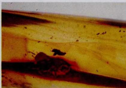
图2 压固琥珀内部的红褐色纹路 10×
