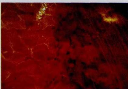
图4 再造琥珀内部颗粒的接触面边界 10×
